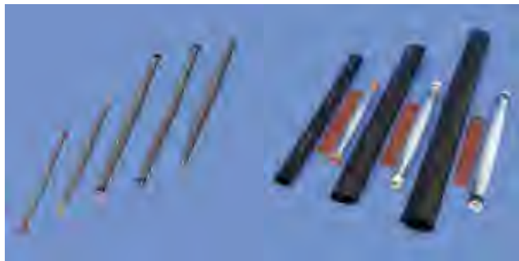
Рис. 5.11. Автоматические натяжные соединительные зажимы и зажимы с принадлежностями для всех типов неизолированных и защищенных проводов, которые предварительно оголены. Зажимы надежны и просты в монтаже. Монтаж не требует инструмента. Надежность соединения обеспечивают секторные клинья.
