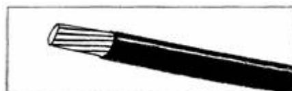
Рис. 10. Конструктивное выполнение защищенного провода SAX
